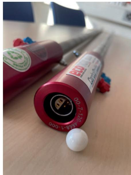
d'énergie de combustible (grâce à une cuisson économique), d'obtenir des couleurs d'émaillage fiables (en connaissant le bon niveau de réduction de chaque cuisson) et de réduire la pollution dans l'air (en diminuant la consommation de combustible). Les sondes à oxygène permettent également de mesurer le potentiel carbone d'une atmosphère.
